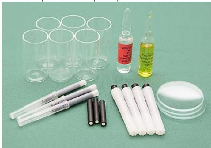
Комплект содержит комплектующие, необходимые для определения ртути методом инверсионной вольтамперометрии на анализаторе вольтамперометрическом TA-Lab. Комплект используют при реализации ГОСТ и методик измерения содержания ртути:
