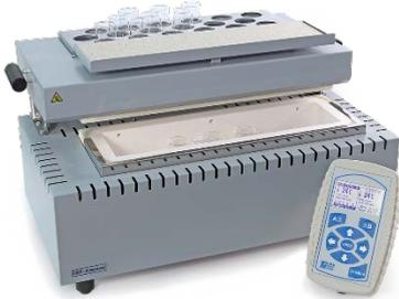
Программируемая двухкамерная печь ПДП-Аналитика имеет закрытую муфельную камеру (камера озоления) и размещенную на ней нагревательную плиту (камера выпаривания). Процессы выпаривания и озоления проводятся при контроле температуры и времени, что повышает удобство и эффективность процесса пробоподготовки.
