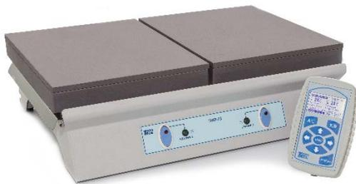
Плита ПЛП-03 имеет две секции нагрева. Секции нагрева могут работать по отдельности или совместно. Управление и контроль за работой секций плиты проводят с помощью пульта управления.
