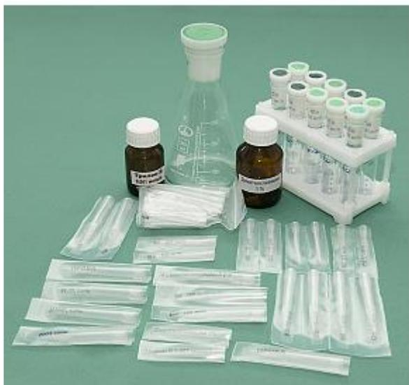
Комплект используют при реализации методик измерения содержания никеля и кобальта:
