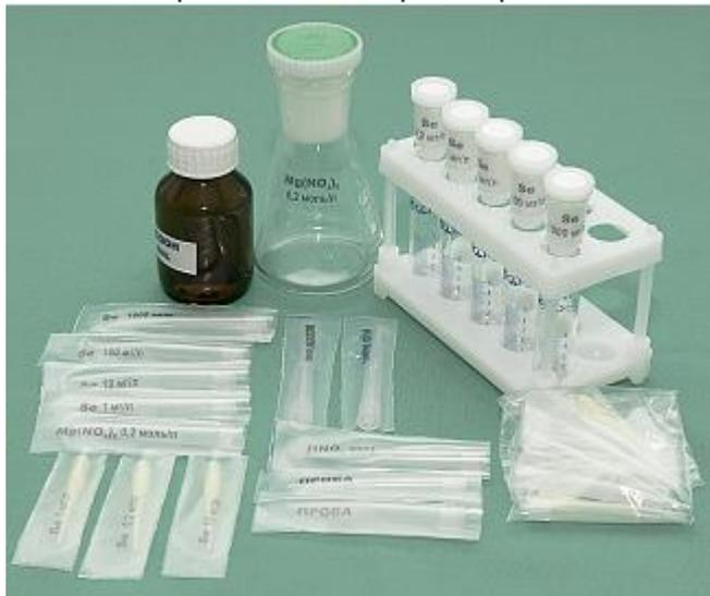
Комплект содержит комплектующие, необходимые для определения селена методом инверсионной вольтамперометрии на анализаторе вольтамперометрическом TA-Lab. Комплект используют при реализации методик измерения содержания селена:
