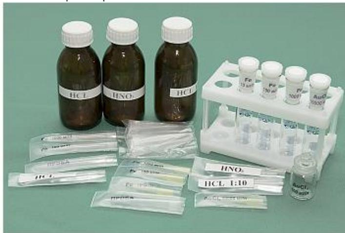
Комплект содержит комплектующие, необходимые для определения железа методом вольтамперометрии на анализаторе вольтамперометрическом TA-Lab. Комплект используют при реализации методики измерения содержания железа:
